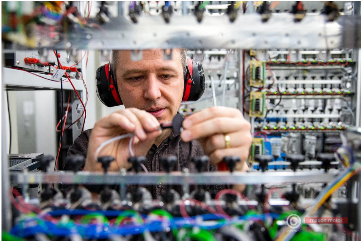
Martin Odermatt, Entwicklungsingenieur bei maxon, überprüft einen Motor. In dieser Temperaturkammer wird ein ExoMars-Antrieb auf das Erfüllen der geforderten Performance bei verschiedenen Temperaturen getestet.
